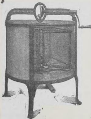
Lo Smelatore Automatico Ceccarelli accoppia alla massima semplicità la completa sicurezza del suo funzionamento - Esso è fornito di Porta-telaini riversib. li automaticamente. Questa riversione dei porta-telaini si ottiene con il solo invertire il movimento evitando così la seccante necessità di dovere estrarre, rivoltare e riporre i telaini. - La trasmissione del movimento è a ingranaggio verticale o a ingranaggio elicoidale.
